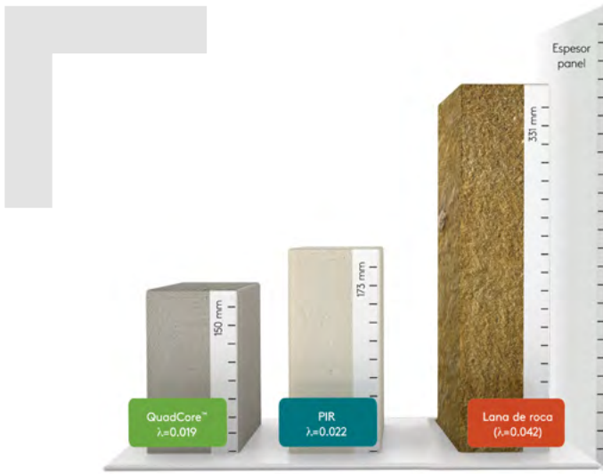
Comparativa de espesores basada en una equivalencia de transmitancia térmica (U) de 0,124 W/m 2 K y en la conductividad térmica del núcleo envejecido ( \lambda ), para paneles HI-QuadCore 2.0 FK, HI-PIR y LR de Huurre.
